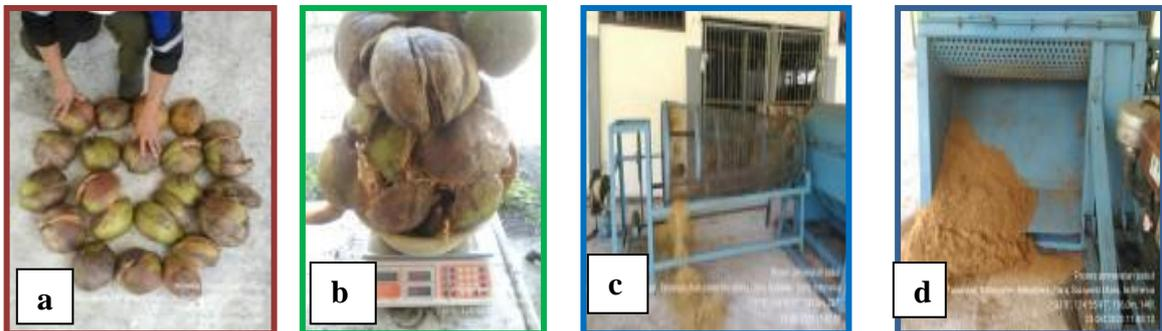
Gambar 37. a) Bahan baku sabut kelapa, b) Penimbangan sabut, c) Proses penyeratan sabut, d) Debu sabut
