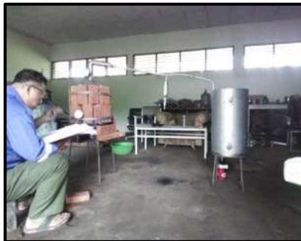
Gambar ..... Proses pirolisis debu sabut kelapa menjadi asap cair
