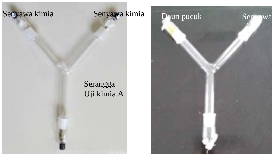
Gambar 2. Pengujian penciuman imago Brontispa longissima dengan menggunakan Olfactometer
